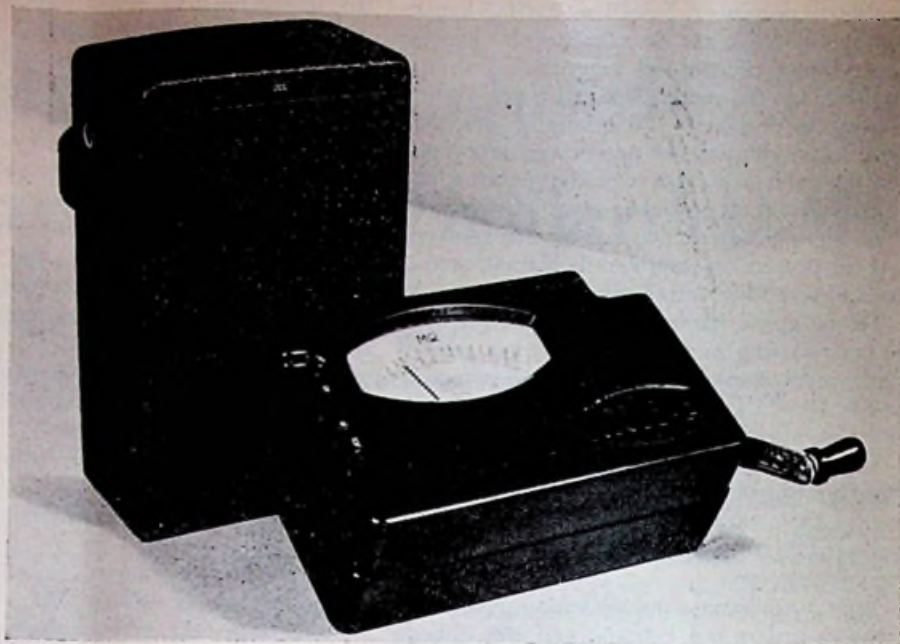
Draagbare isolatietester met kruisspoel instrument Type 126 ISOLEKA
