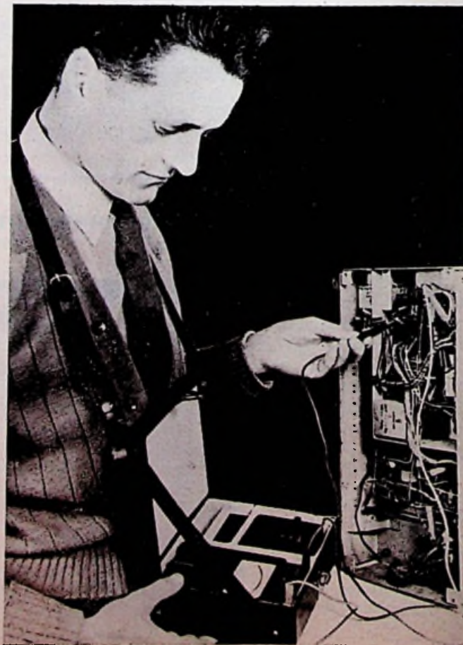
Universeel meetinstrument voor stroom-, spannings- en weerstandsmetingen Type UNIVO
